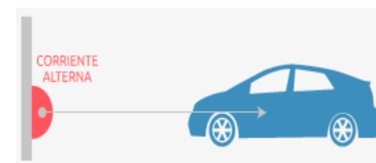
Figura 2. Carga en base de una toma de corriente de uso no exclusivo.
