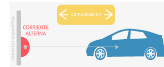
Figura 4. Carga en base de una toma de corriente especial para uso exclusivo a la recarga del vehículo eléctrico.
