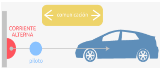
Figura 3. Carga en base de una toma de corriente estándar de uso no exclusivo con protección incluida en el cable.
