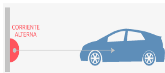
Figura 2. Carga en base de una toma de corriente de uso no exclusivo.
