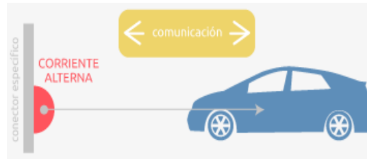
Figura 4. Carga en base de una toma de corriente especial para uso exclusivo a la recarga del vehículo eléctrico.
