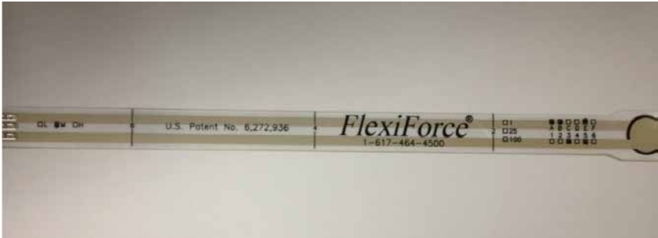
Fig. 12. Sensor de presión para falange distal
