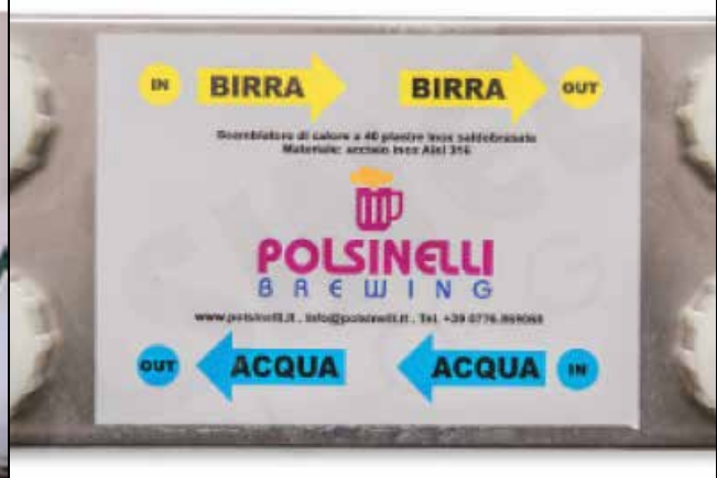
Fig. 4 Intercambiador de Placas Marca Polsinelli
