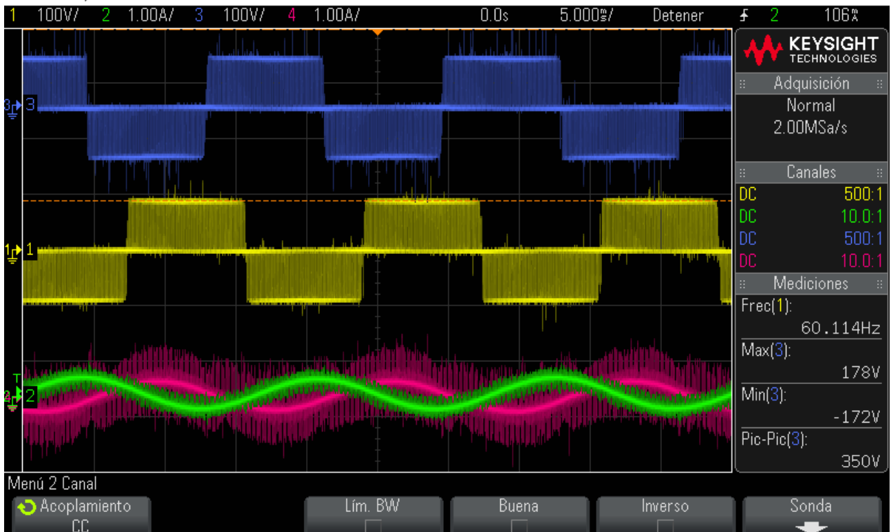
Figura 8: Resultado de voltajes y corrientes con carga en inversor
