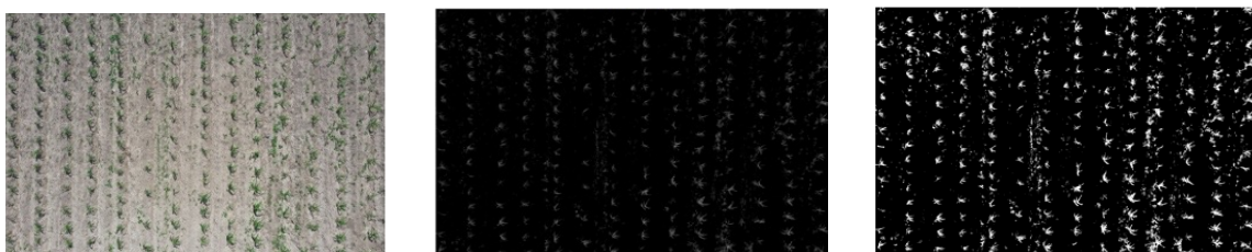
(a) Imagen original (b) Imagen en escala de grises (c) Imagen binaria Figura 2: Ejecucin de las fases algoritmo secuencial y paralelo para segmentar imgenes digitales
