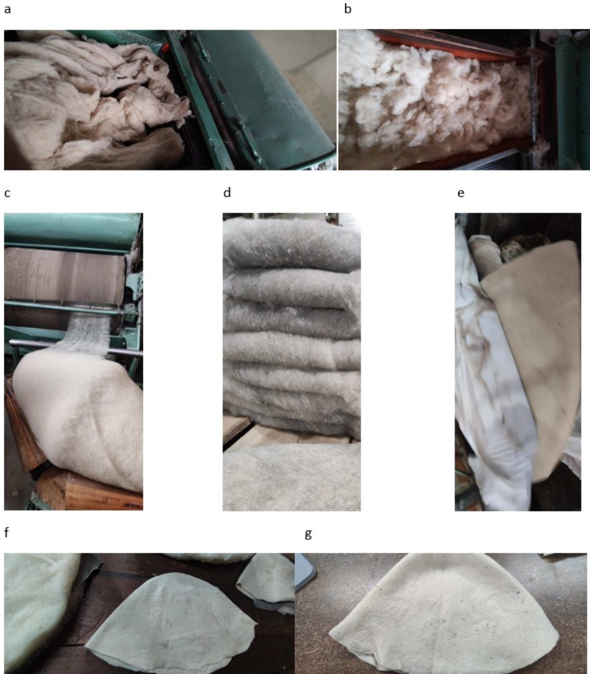
Fig. 2. (a) abridora y mezcla, (b) alimentación carda, (c) envoltura de velo en carda, (d) colchón formado con capas de velo de carda, (e) Planchado enfieltro, (f) no tejido planchado (g) no tejido en forma de cono seco.
