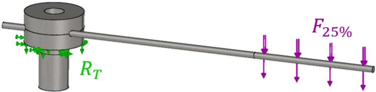
Fig. 6. Condiciones de contorno para las torretas de fijación.
