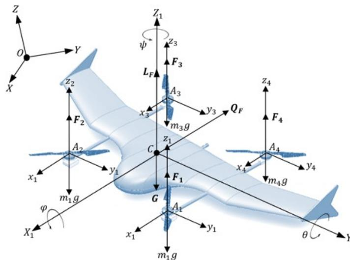
Fig.4. Esquema de cálculo del RPA:  $F_i$  – vector de la fuerza de empuje de los rotores;  $G$  – vector gravitacional;  $L_F, Q_F$  – vectores de fuerzas aerodinámicas sobre la superficie alar y fuselaje
