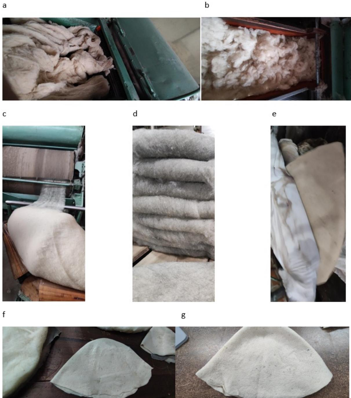
Fig. 2. (a) abridora y mezcla, (b) alimentación carda, (c) envoltura de velo en carda, (d) colchón formado con capas de velo de carda, (e) Planchado enfieltado, (f) no tejido planchado (g) no tejido en forma de cono seco.
