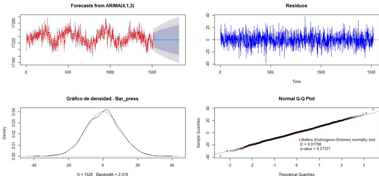
Fig.4. Modelo ARIMA para la Presión Barométrica.
