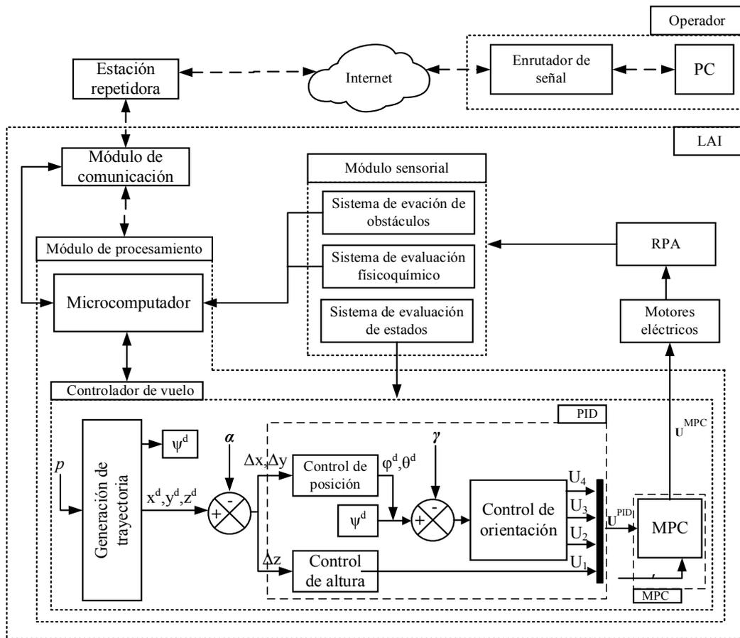
Fig.5. Esquema generalizado de arquitectura de control del LAI
