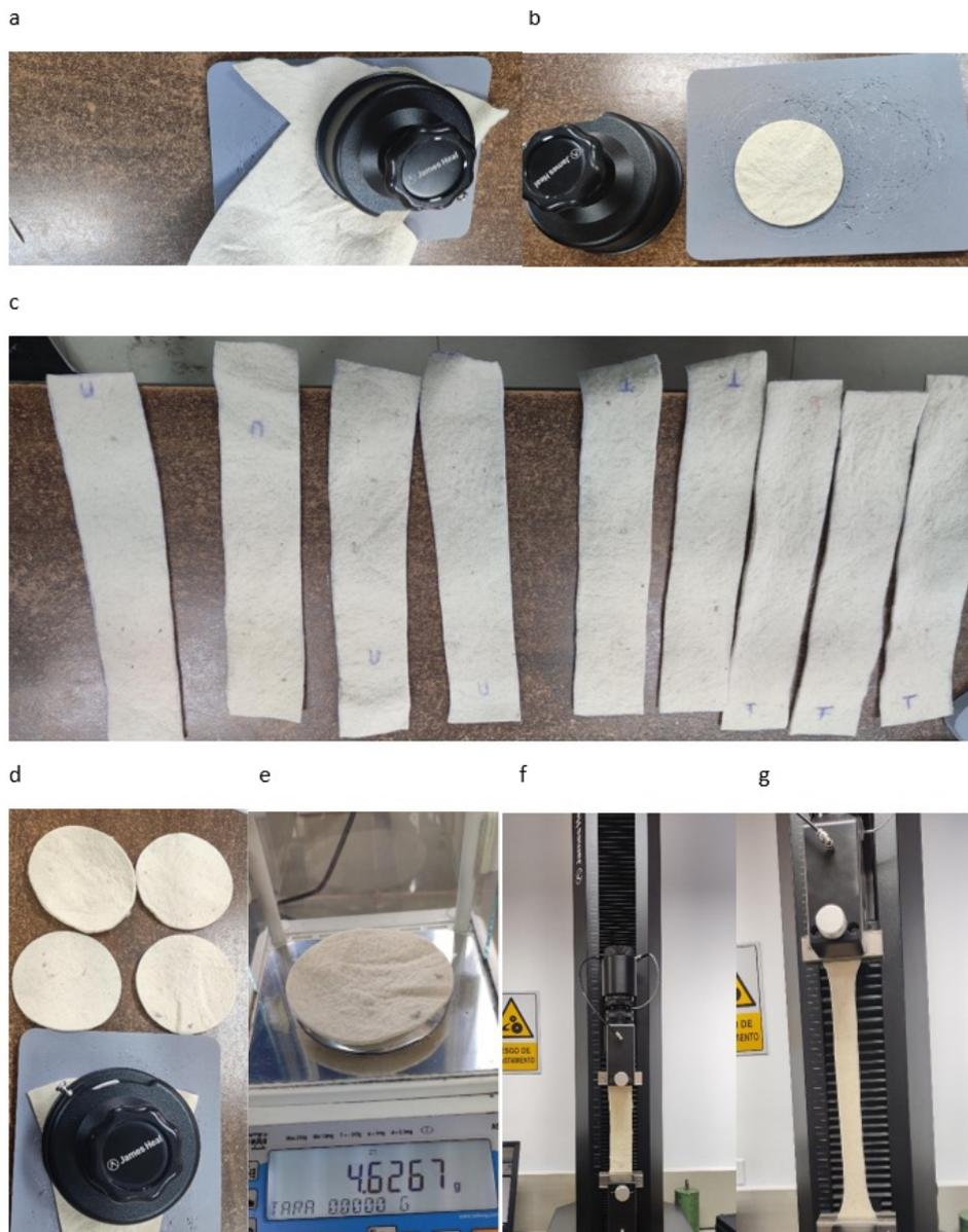
*Fig. 3. Proceso de análisis en laboratorio. (a) corte circular de muestra sobre superficie plana eva por unidad de área. (b) forma de corte circular 10cm. (c) corte de muestras 5 x 25 cm de ancho y altura. (d) muestras cortadas. (e) peso de muestra en balanza. (f) dinamómetro colocado la muestra antes de realizar el análisis. (g) muestra realizando el análisis de Resistencia a la tracción, elongación, tiempo de rotura y energía a la rotura en el dinamómetro Titan 5.*
