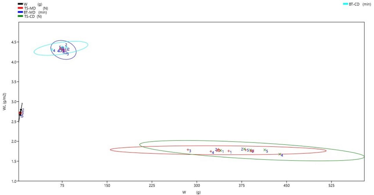
*Fig. 4. Similitud entre peso (W), Resistencia a la tracción dirección de máquina (TS-MD), tiempo de rotura dirección de máquina (BT-MD) Resistencia a la tracción dirección contraria (TS-CD), tiempo de rotura dirección contraria (BT-CD).*
